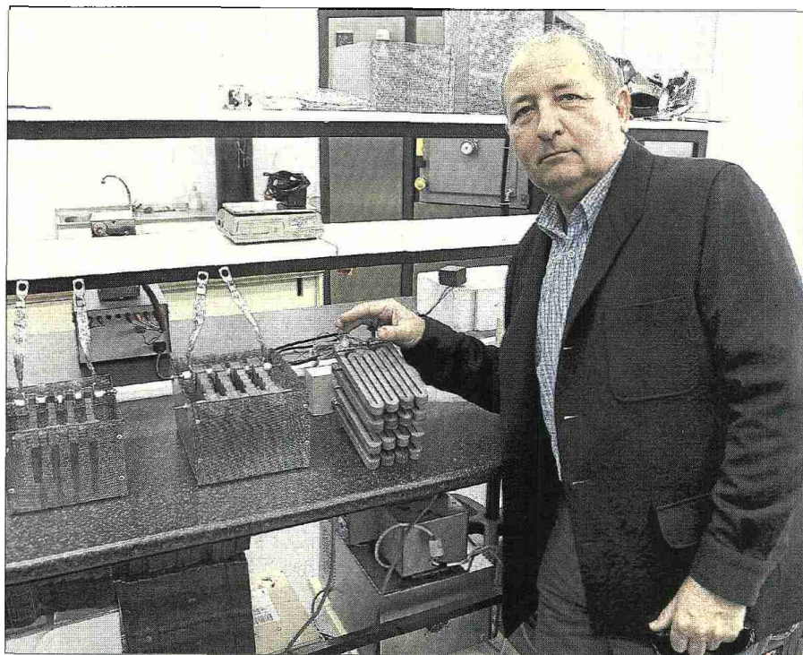
El físico Hipólito Miranda, de Biomorphic, enseña resistencias de carburo de silicio hecho a partir de madera. / FERNANDO RUISO
